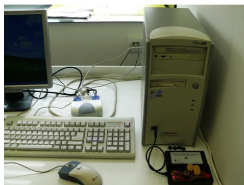
Obrázek 9 - Experiment radioaktivního pozadí (Zdroj: http://www.ictphysics.upol.cz/remotelab/fotogalerie/GM%20counter2.png )
