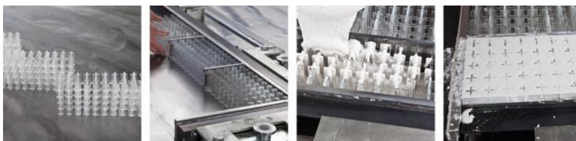
Výrobní postup betonu LiCrete®
