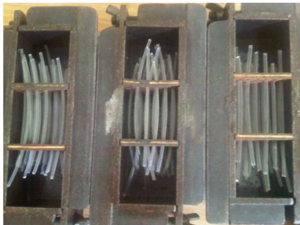
Obr. O19: Nerezová forma pro protahování [O19]
