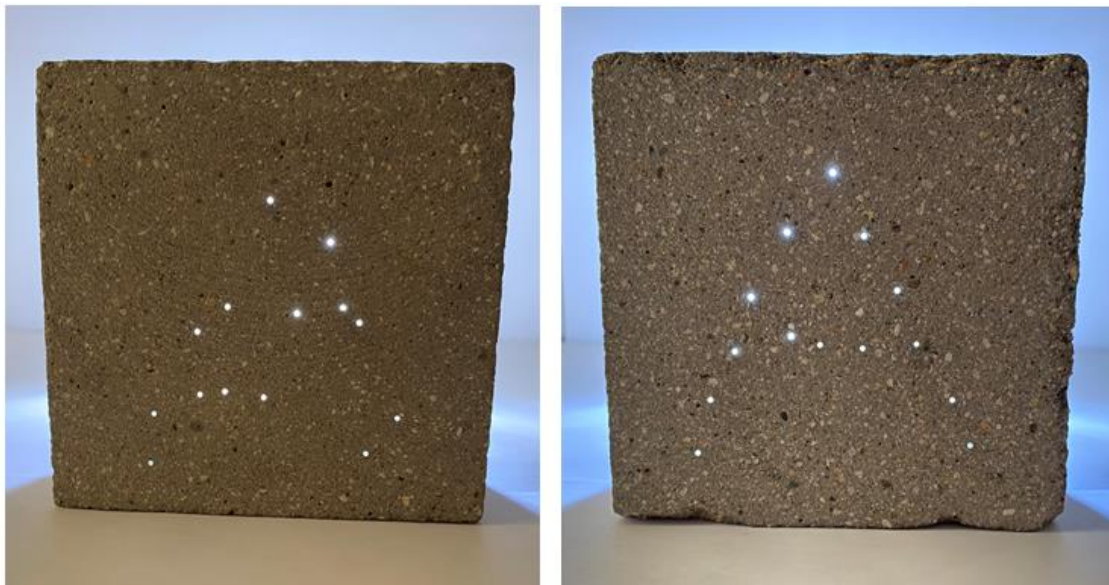
Obr. O38: Vzorky vyráběné metodou zabadávání – vlevo nekotvená vlákna, vpravo vlákna kotvená do podložky
