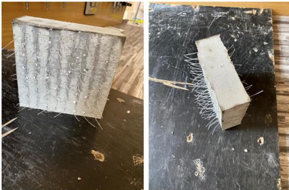
Obr. 043: Odformované vzorky pro zkoušení prostupu světla s průměrem vláken 1 mm
