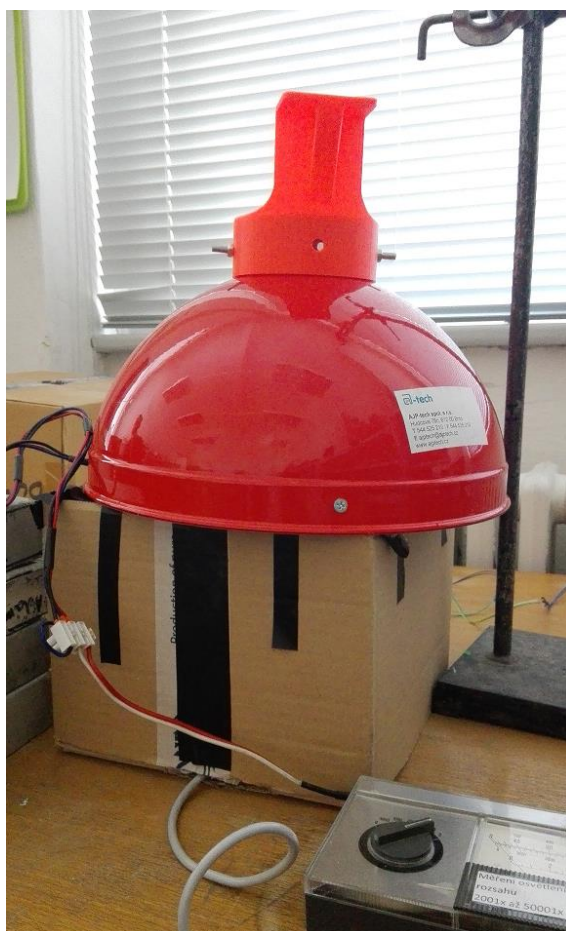
Obr. 044: Zkušební sestava pro měření prostupu světla celým vzorkem
