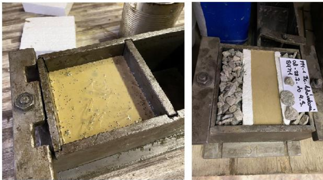
Obr. O42: Osazení vláken a následné zalití betonovou matricí: vlevo forma s polystyrenovou podložkou pro zabodávání, vpravo osazení polystyrénových desek s protaženými vlákny
