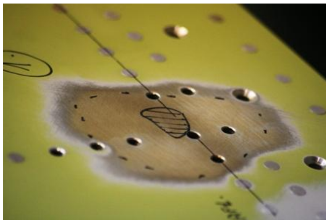
Obr. 23: Chromátování přípravkem Alodine 1200
