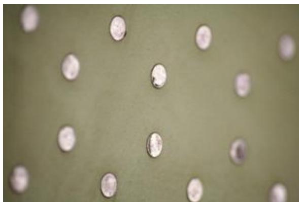
Obr. 20: Zápusné nýty po instalaci do potahu letadla
