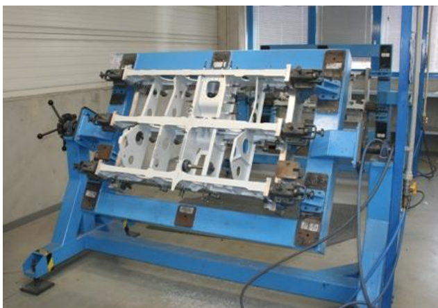
Obr. 17: Přípravek pro nýtování podsestavy dveří letadla
