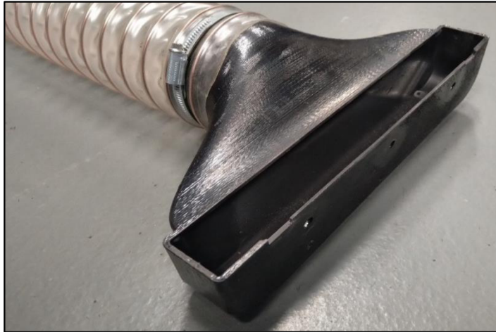
Obr. 14 – 3D tištěný náfuk odsávání
