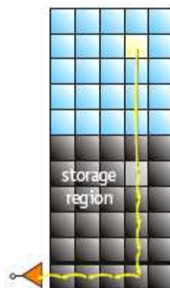
Obrázek 2.5: Frame - Transfer CCD
