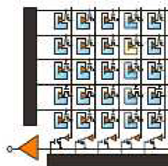
Obrázek 2.6: PPS - Passive Pixel Sensor
