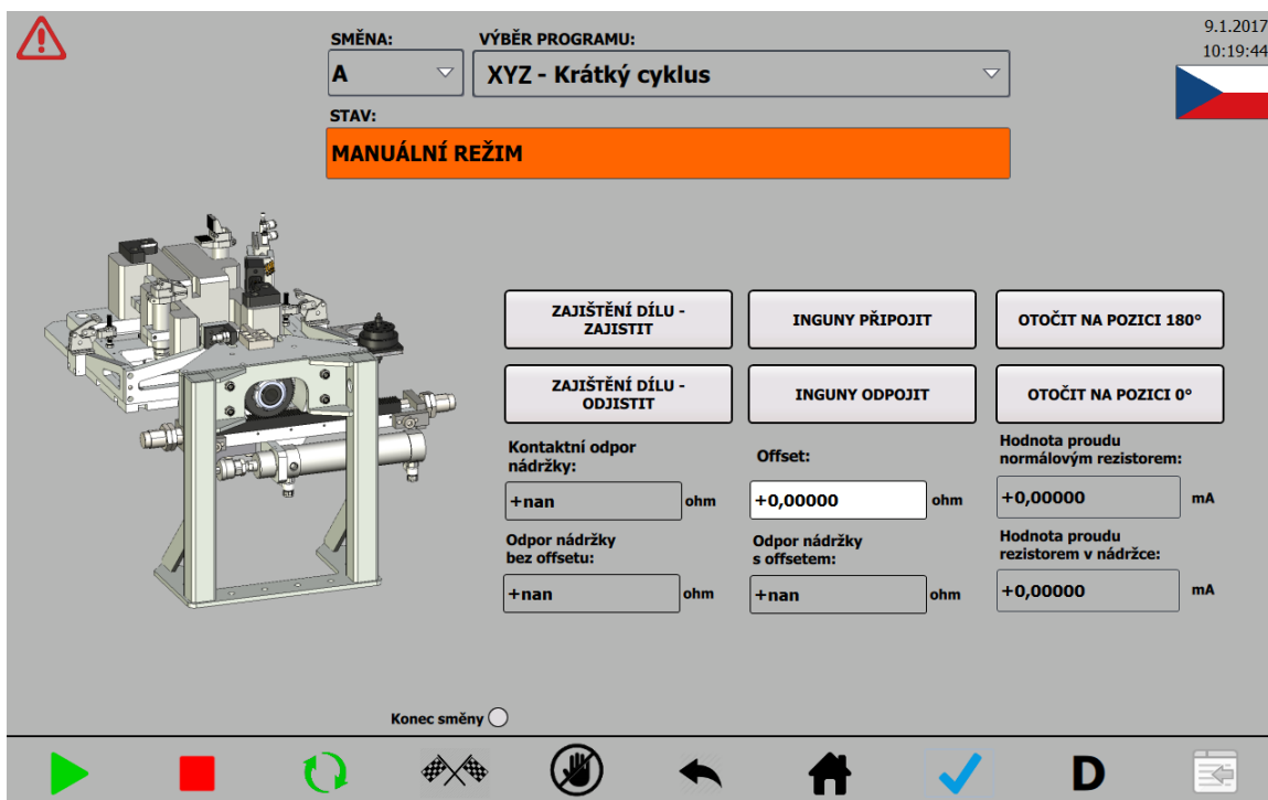
Obr. 4.9: Manuální režim - elektrický test
