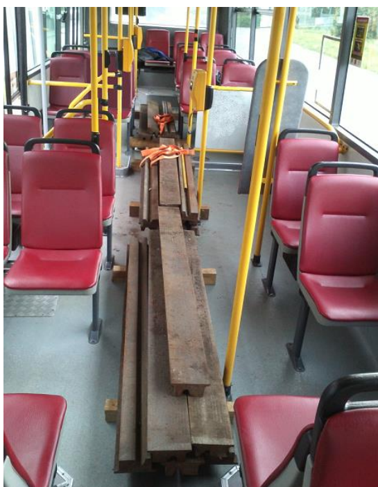
Obrázek 18 – zátěž simulující obsazenost vozu
