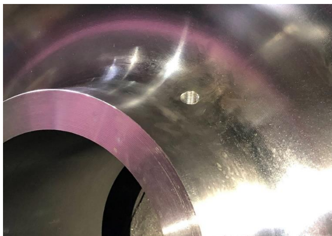
Obr. 15) Injekční otvor na železničním kole
