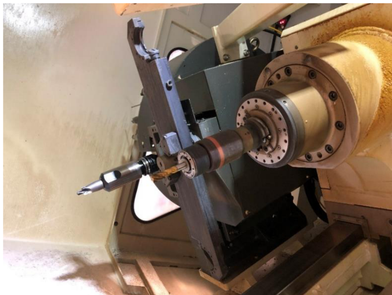
Obr. 10) Pohled na vřeteno s upnutým závitníkem a výměník nástrojů
