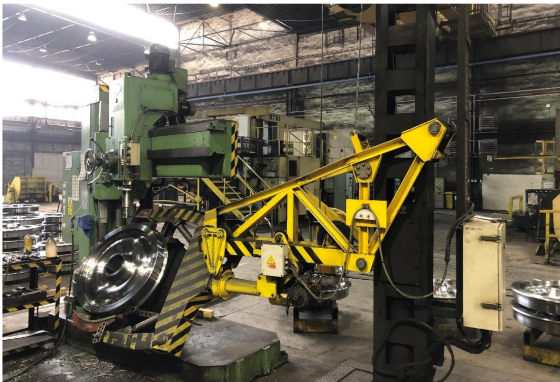
Obr. 7) Vertikální vrtačka s kolem usazeným na naklápěcím stole ve firmě Bonatrans
