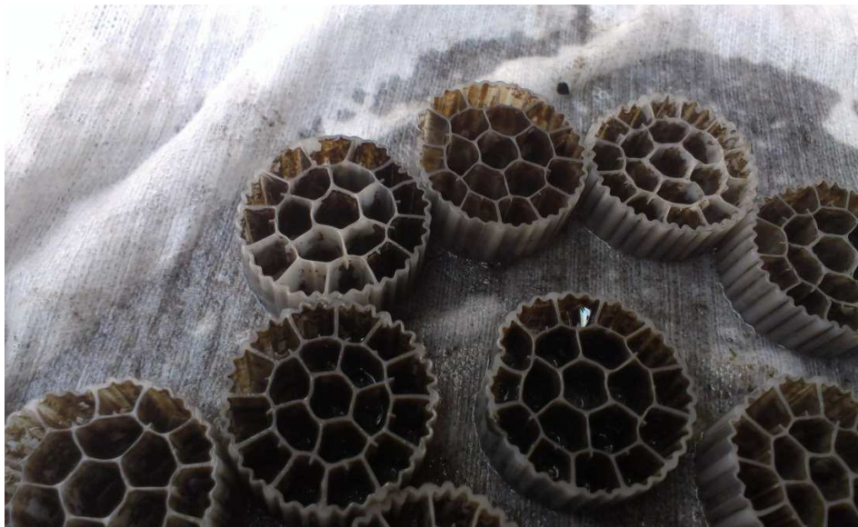
Obr. 12 Tělíska Kaldnes – předčištění průmyslových odpadních vod
