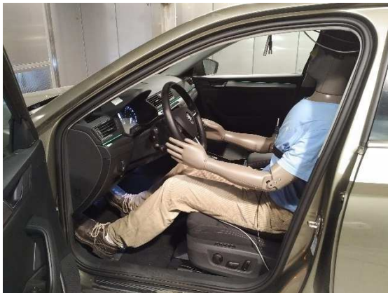
Obr. 6.1 Manekýn umístěný v Superbu po dobu testu Obr. 6.2 Použitý automobil k testování Simulátoru
