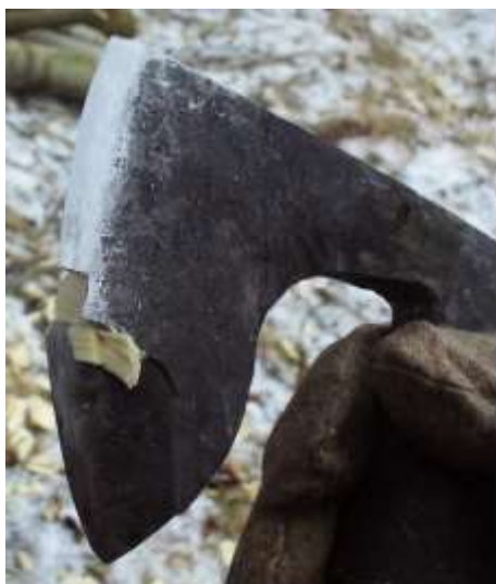
Obr. 76 Poškození ostří repliky historické sekyry. foto autor 2014
