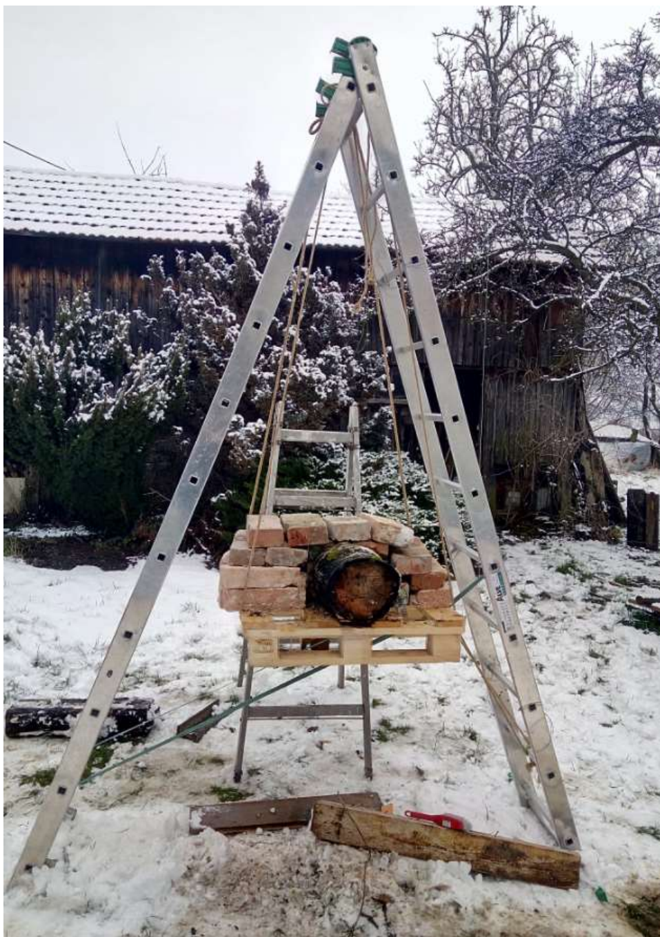
příl. 17 Balistické kyvadlo použité pro výpočet dopadové energie sekyr. b) pohled na úderovou plochu. foto P. Voda 2018
