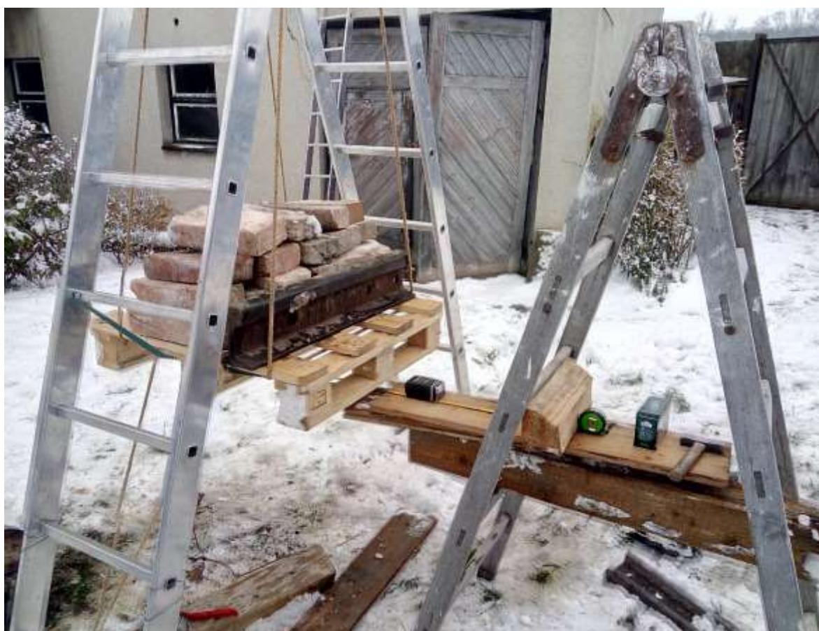
přil. 17 Balistické kyvadlo použité pro výpočet dopadové energie sekyr. a) pohled na měřicí stupnici. foto P. Voda 2018
