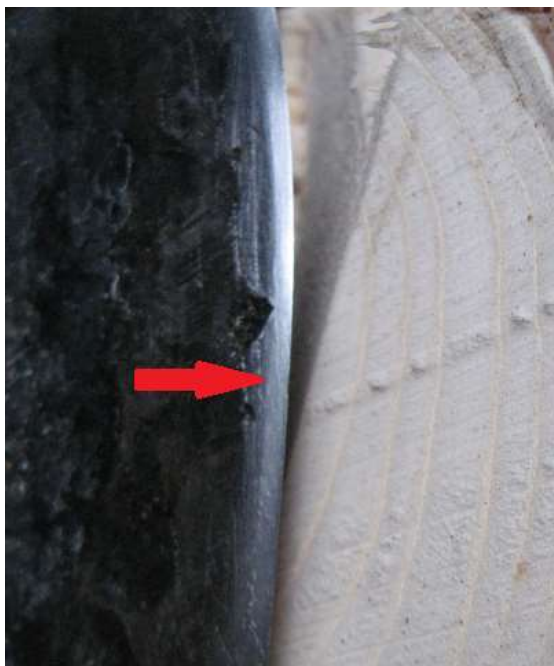
obr. 82 Nerovnost ostří repliky historické sekyry menší smrk, poř. č. než 0,5 mm a její projev na hmotě dřeva. smrk, poř. č. 51, foto P. Pokorný
