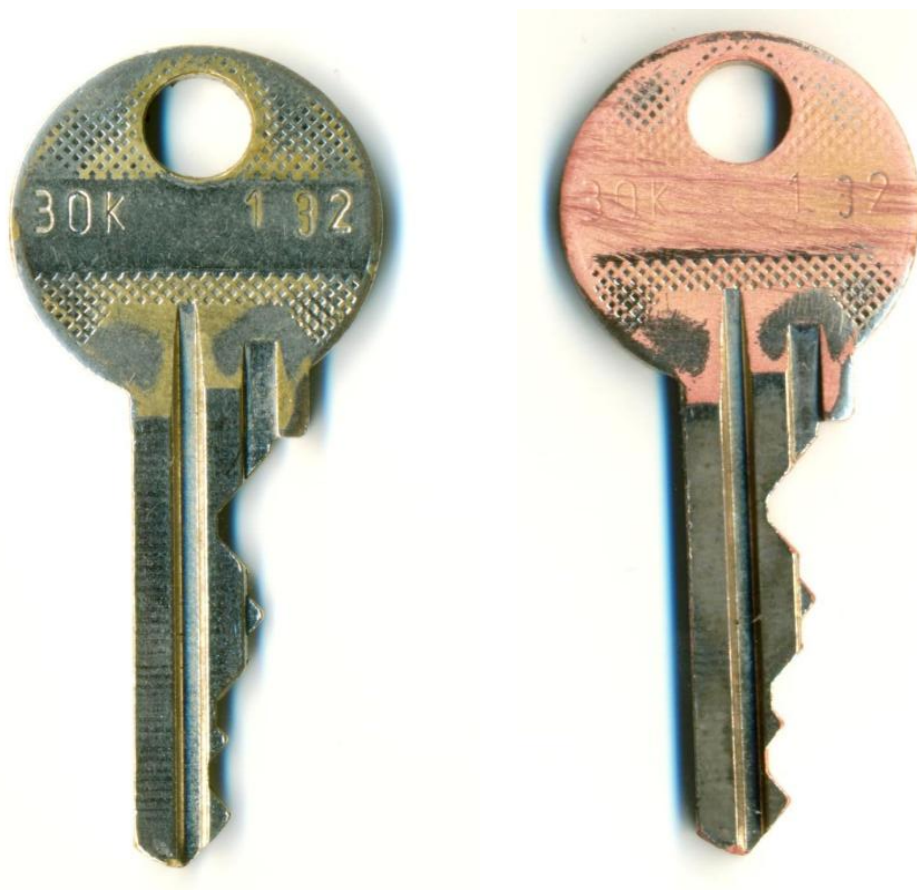
Obr 15: zvýraznění identifikačního čísla na klíči, pomocí leptacího roztoku
