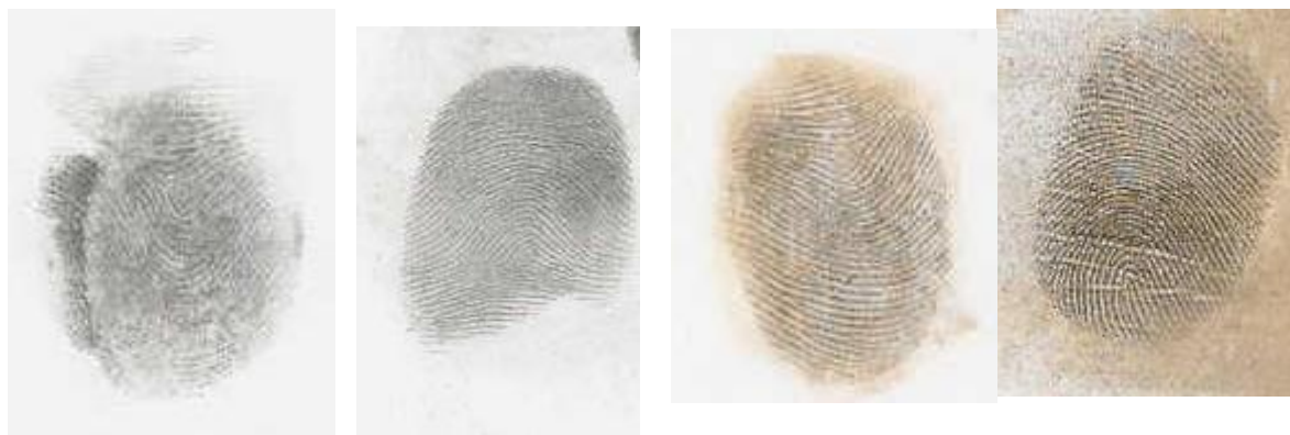
Obr 9: Otisky zvýrazněné pomocí práškového grafitu a železného prachu
