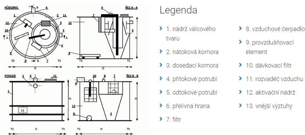
Obr. 4. Schéma DČOV Ekocis s popisem (Ekocis-čističky odpadních vod, 2020)
