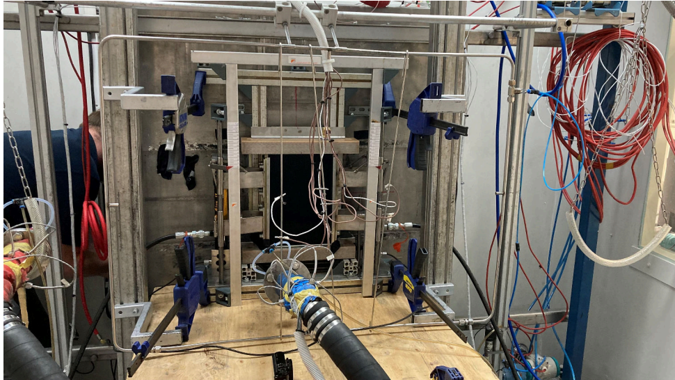
Obrázek 4.8: Výměník v zařízení pro napínání v kalorimetrické zkušebně
