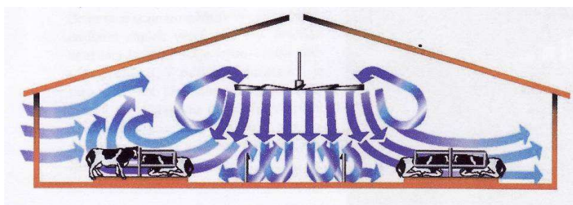
Obr. 2.10 Zobrazení proudu vzduchu u horizontálního ventilátoru
