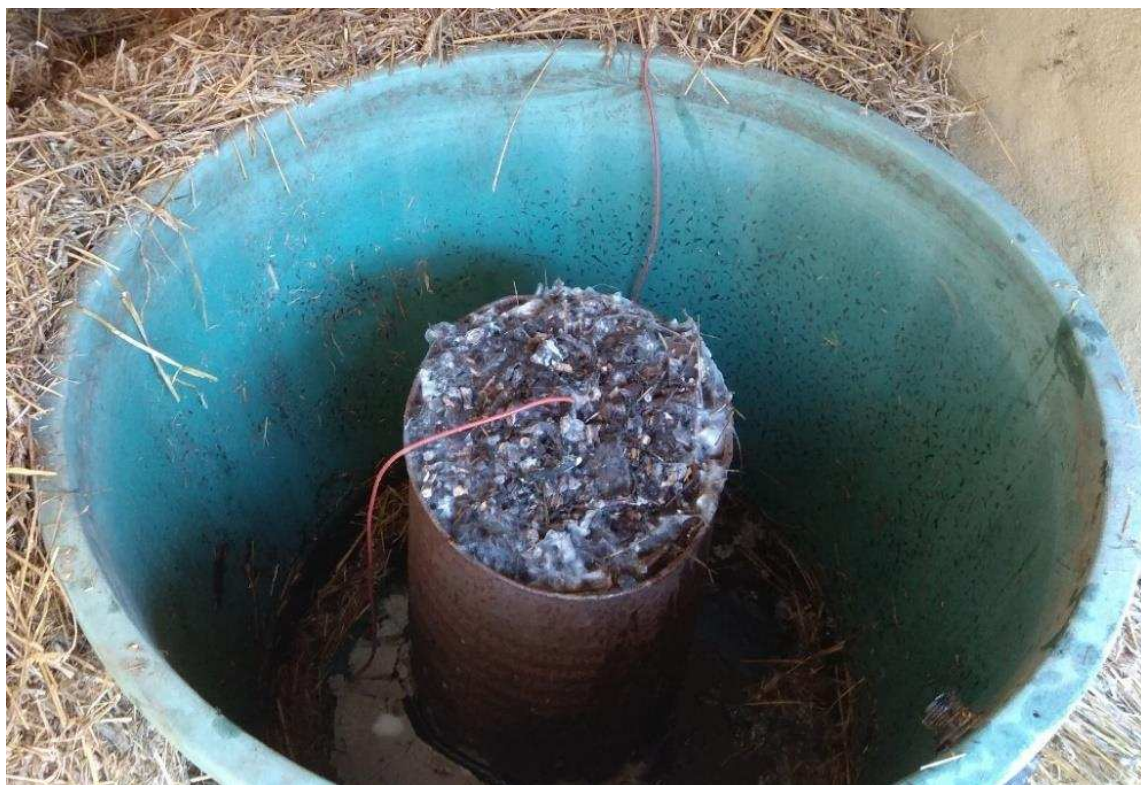
Obrázek 25 Rozdělaný fermentor po pokusu
