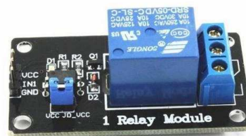
Obrázek 40 Modul relé 5 V [27]
