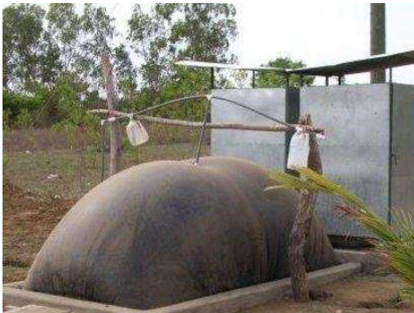
Obrázek 29 Fermentor ve vaku [25]
