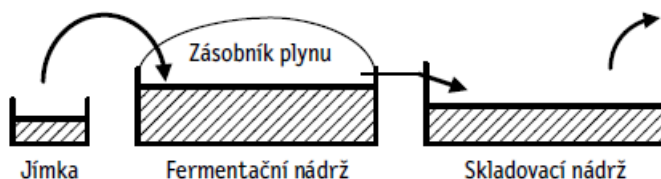
Obrázek 11 Schéma průtokové metody [1]
