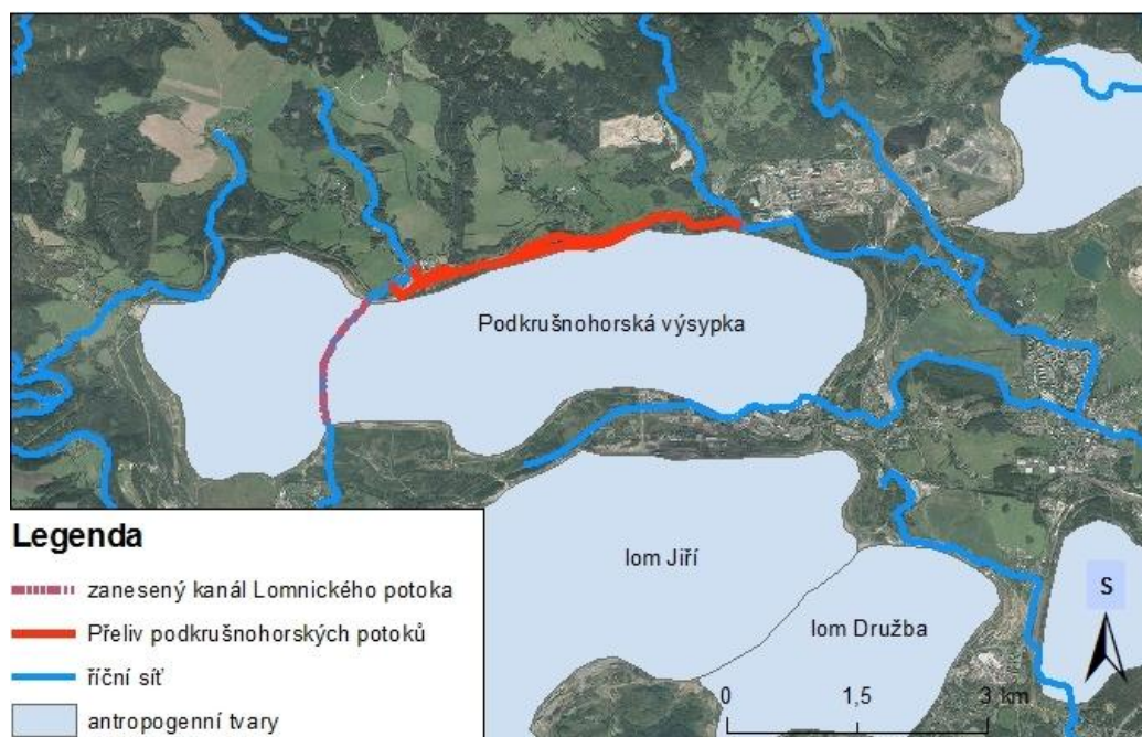
Obr. 14 Nepovedená přeložka Lomnického potoka v roce 1991
