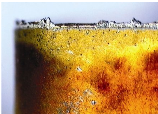
Obrázek 25. Nárůstek na řezné hraně nástroje [49].
