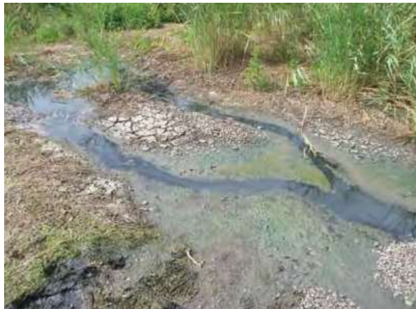
Obrázek 2: Privilegovaný povrchový odtok v důsledku kolmatace [1]
