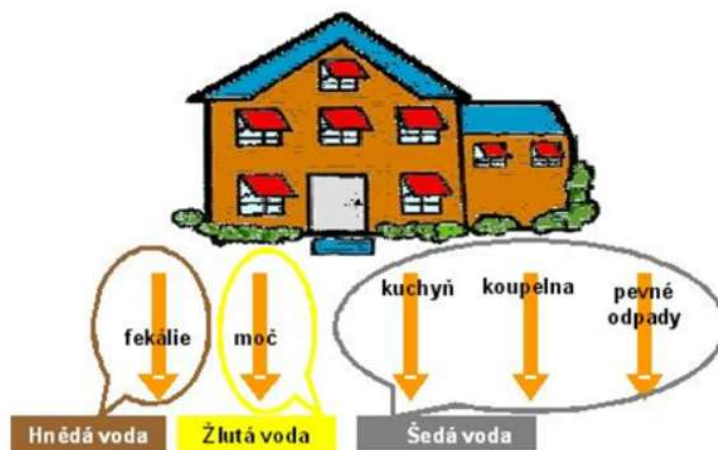
Obrázek 1: Dělení odpadních vod v domácnostech [10]
