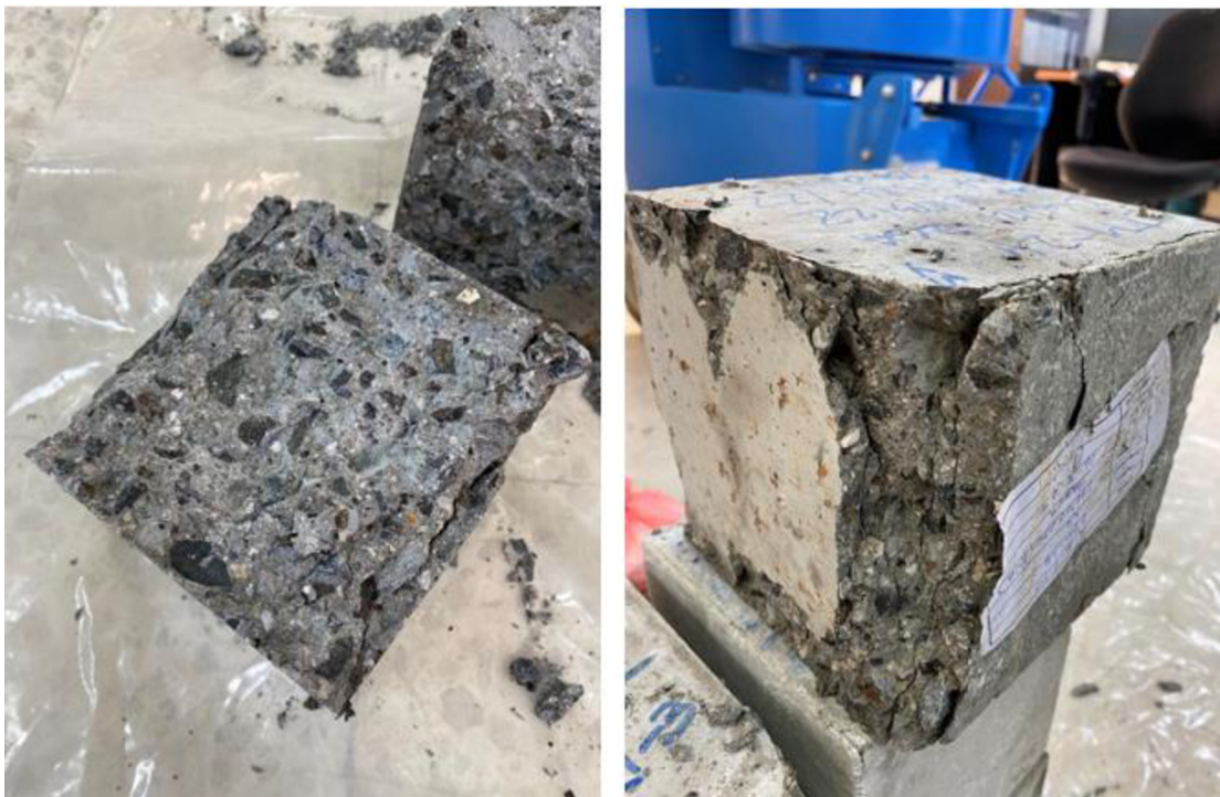
Obrázek 18: Vzorky po stanovení pevnosti v tlaku
