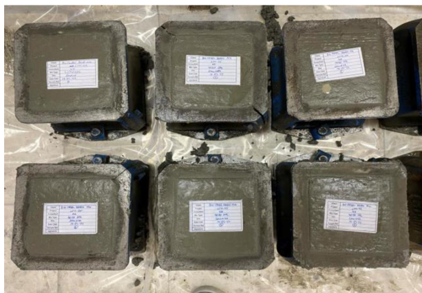
Obrázek 17: Vzorky po zjištění objemových hmotností na čerstvém betonu
