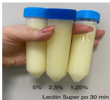
Obr. 64 LS v cukerném roztoku → emulzifikace pomocí tyčového mixéru po 30 min
