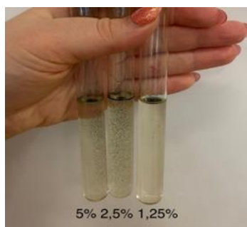
Obr. 48 Promíchání ve vortexu po 15 min
