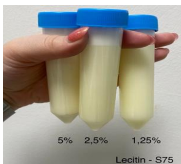
Obr. 66 L-75 v cukerném roztoku → emulzifikace pomocí tyčového mixéru
