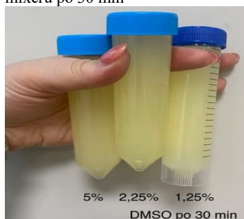
Obr. 70 DMSO v cukerném roztoku → emulzifikace pomocí tyčového mixéru po 30 min
