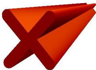
Obr. 25: X-kríž slúžiaci na oddelenie párov. (7, s. 41)
