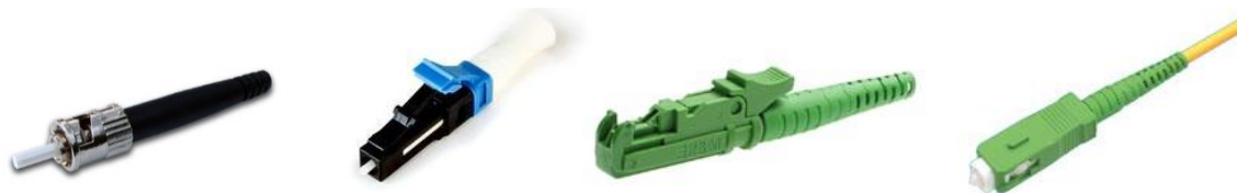
Obr. 32: Optické konektory pre sklenené vlákna (zľava ST konektor, LC konektor, E2000 a SC konektor). (7, s. 144, 145 a 150)
