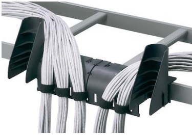
Obr. 64: Prvok pre zaistenie polomeru ohybu trás. (10)
