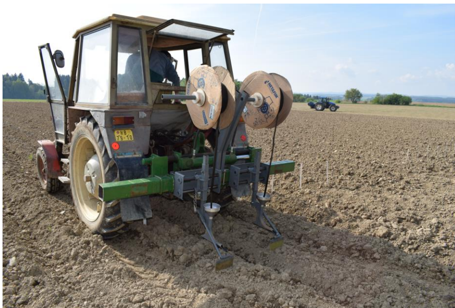
Obr.3: Pokládání hadic za pomoci pokládacího zařízení
