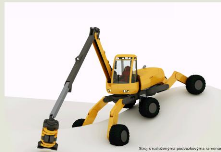
Stroj s rozloženými podvozkovými rameny
