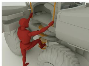
Vstup do kabiny
