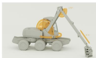
Pohyb pracovního ramene Rameno je umístěno na pravé straně kabiny, tímto řešením je umocněn stálý pohled řidiče na pracovní oblast.
