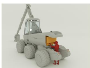
Přístup k chladičům
