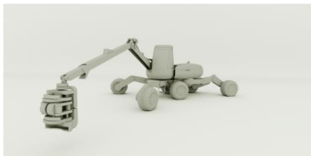
Uspořádání hmot v prostoru Hlavní myšlenkou designu tohoto harvesteru bylo využít rychlý pohyb kol kombinovaný s terénní průchodností robotické chůze.
