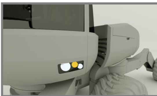
Obr. 5.5 Detail skrytých sacích otvorů
