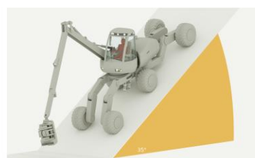
Postavení stroje na kopci Stroj má čtyři rozkládací podvočkové ramena, sloužící ke stabilizaci a k překonávání překážek (rychlouhovou robočickou chůzí)
