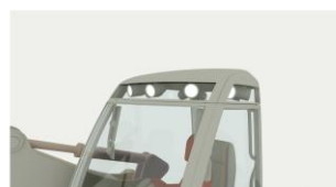
Detail nástavby kabiny Světla umístěná uvnitř kabinové nástavby slouží k osvětlení pracovní oblasti a prostoru kolem stroje.
