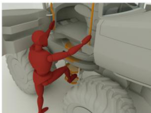
Vstup do kabiny
