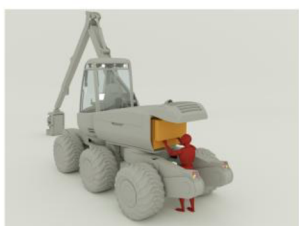
Přístup k chladičům
