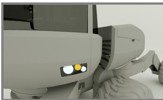
Obr. 5.5 Detail skrytých sacích otvorů
