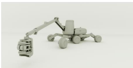
Uspřádání hmot v prostoru Hlavní myšlenkou designu tohoto harvesteru bylo využití rychlý pohyb kol kombinovaný s tenčí průchodností robotické chůze.
