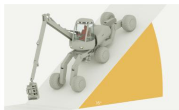
Postavení stroje na kopci Stroj má čtyři rozkládací podvočková ramena, sloužící ke stabilizaci a k překonávání překážek čtyřnohou robotickou chůzí
