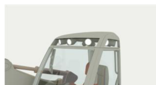
Detail nástavky kabiny Světlá umístěné uvnitř kabinové nástavby slouží k osvětlení pracovního obvodu a prostoru kolem stroje
