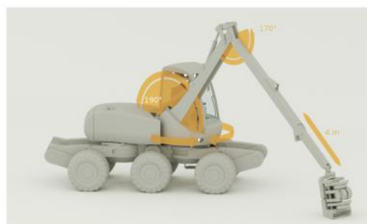
Pohyb pracovního ramene Rameno je umístěno na pravé straně kabiny, tímžle řešením je umožněn stálý pohled řidiče na pracovní oblast.
