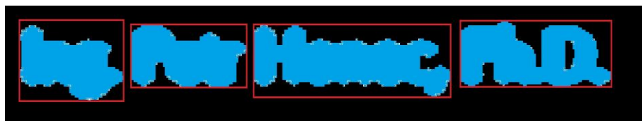
Obrázek 34: Porovnání obsahu minimálního obdélníku a skutečného obsahu objektu
