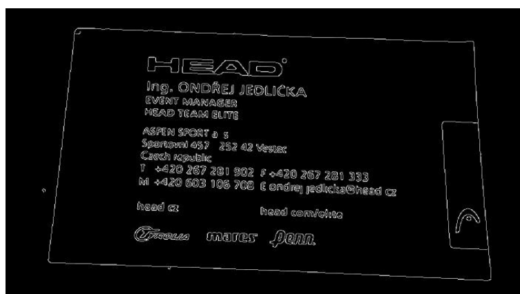
Obrázek 24: Ukázka hran s filtrací šumu Pyramidovým filtrem
