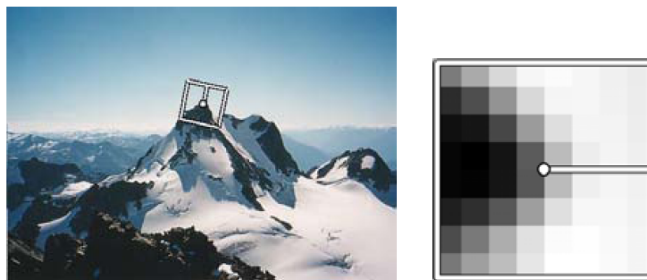
Obrázek 2.3: MOPS deskriptor. Ukázka výřezu 8 x 8 v jedné úrovni. Převzato z [20].
