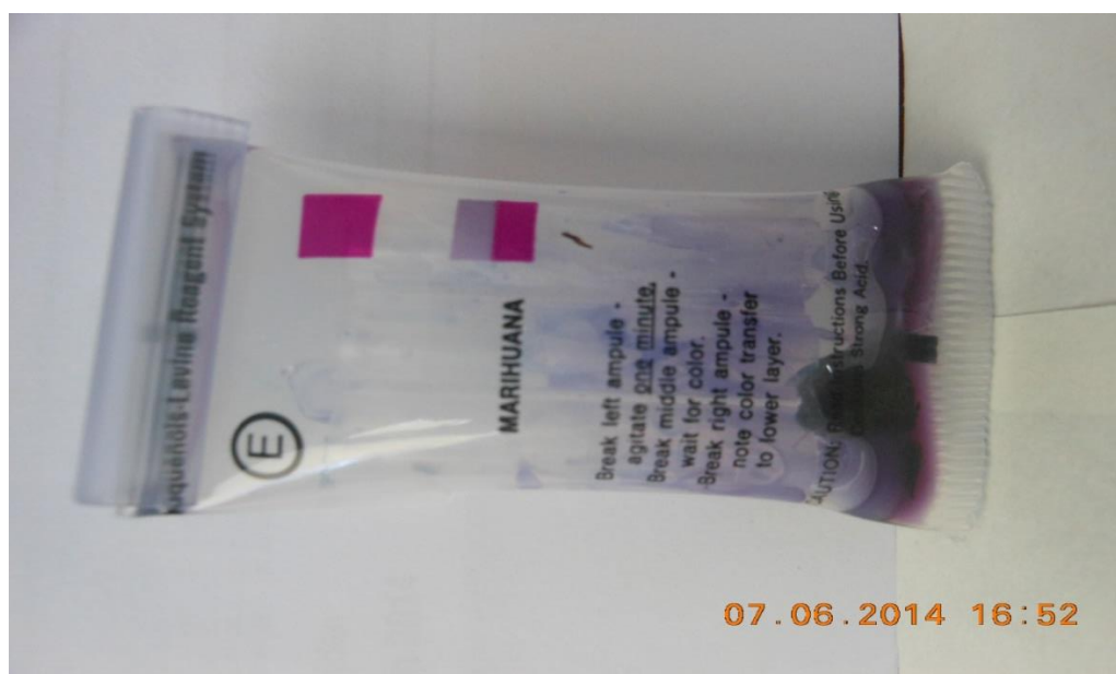
Obrázek 12 Orientační chemická detekce pomocí sady NIK-U - pozitivní reakce[12]
