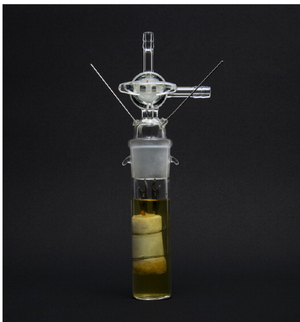
Obr. 2: Replika prvního experimentálního lithiového akumulátoru [10]
