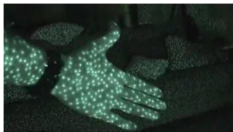
Obrázek 10 Měření hloubky obrazu senzorem Kinect (Flatley, 2010)
