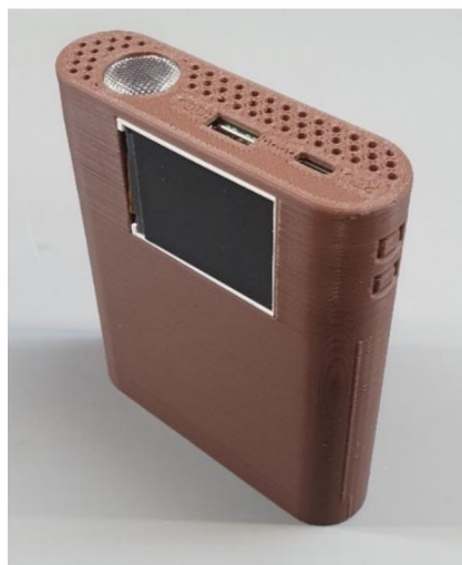
Obrázok 26 Obal vytvorený 3D tlačou s vloženými komponentami
