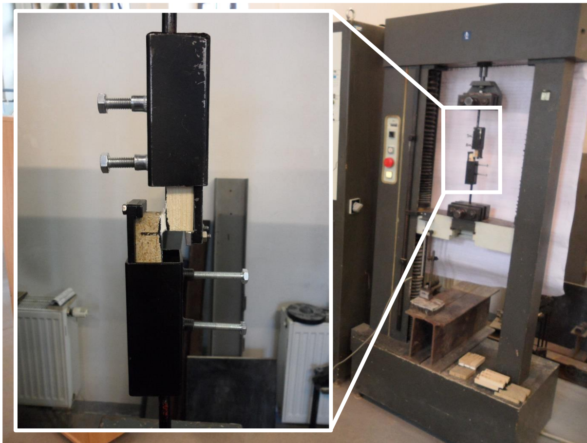
Obrázek č. 22 – Upnutí zkušebního nástavce pro zkoušení pevnosti lepené sestavy ve smyku v lisu
