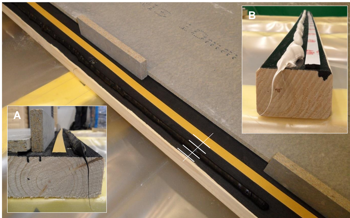
Obrázek č. 40 – Aplikace lepidla: a) systém Dinitrol F500LP Polyflex; b) systém SikaTack® Panel
