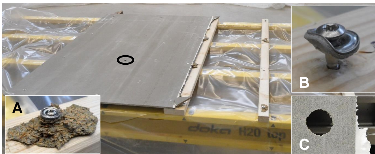
Obrázek č. 90 – Porušení segmentu s mechanickým spojem a obkladem Cetris Basic: a) vytržení obkladu; b) deformace kotevního prvku; c) proražení otvoru v místě kotevního prvku
