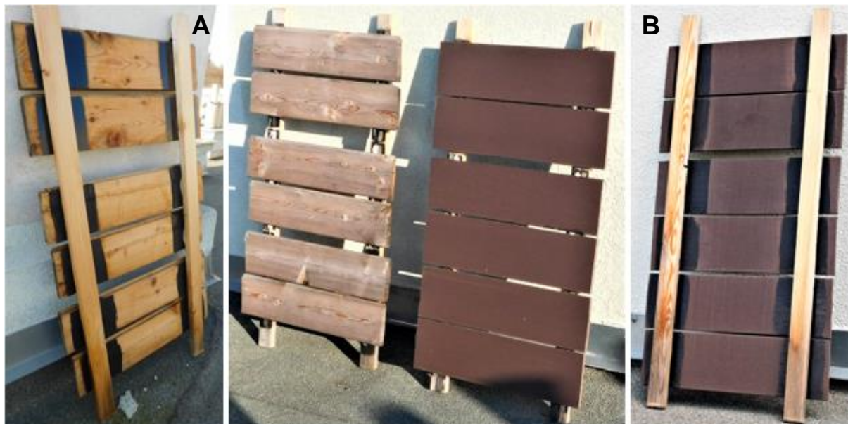
Obrázek č. 43 – Zkušební panel vystavený působení reálného prostředí: a) fasádní palubky; b) WPC;
