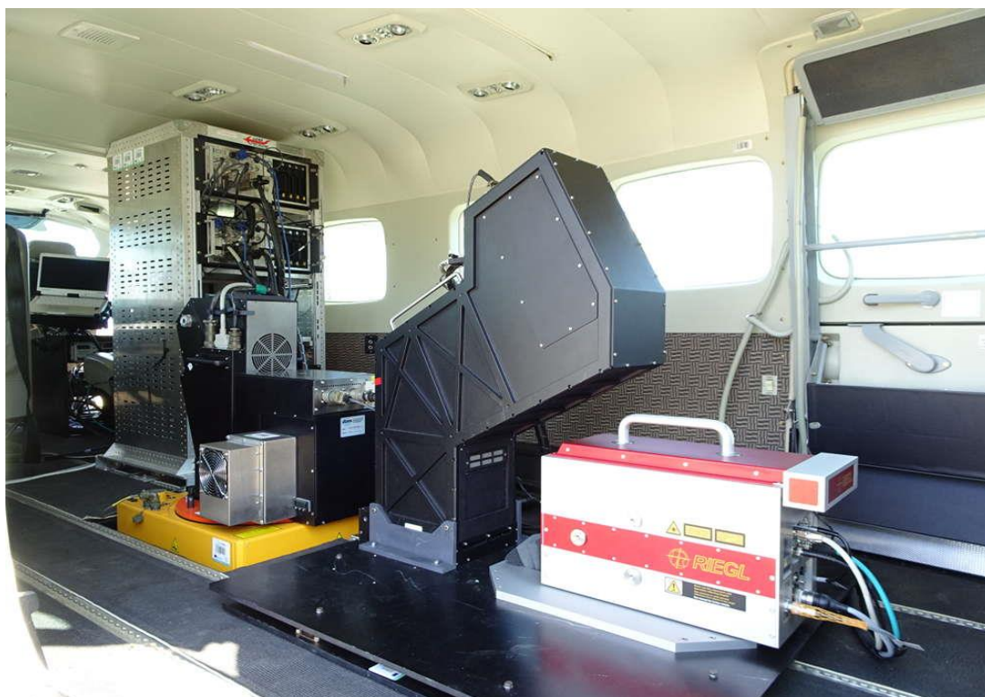
Obrázek 2.14: Přístrojové vybavení FLIS (Oddělení leteckých činností CzechGlobe, 2022).
