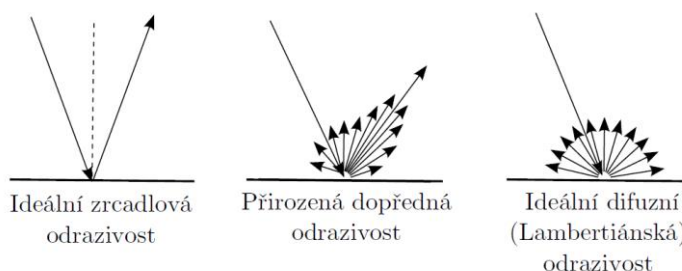
Obrázek 1.6: Tři typy odrazu (Zemek et al., 2014).
