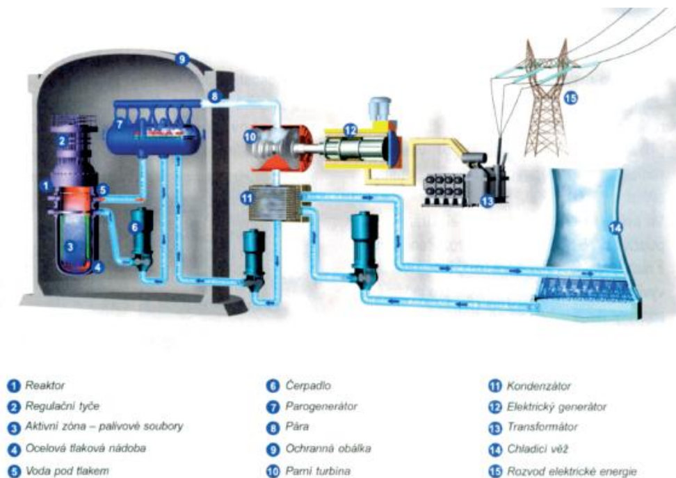
Obr.5.1 Schéma jaderné elektrárny (převzato z [10])
