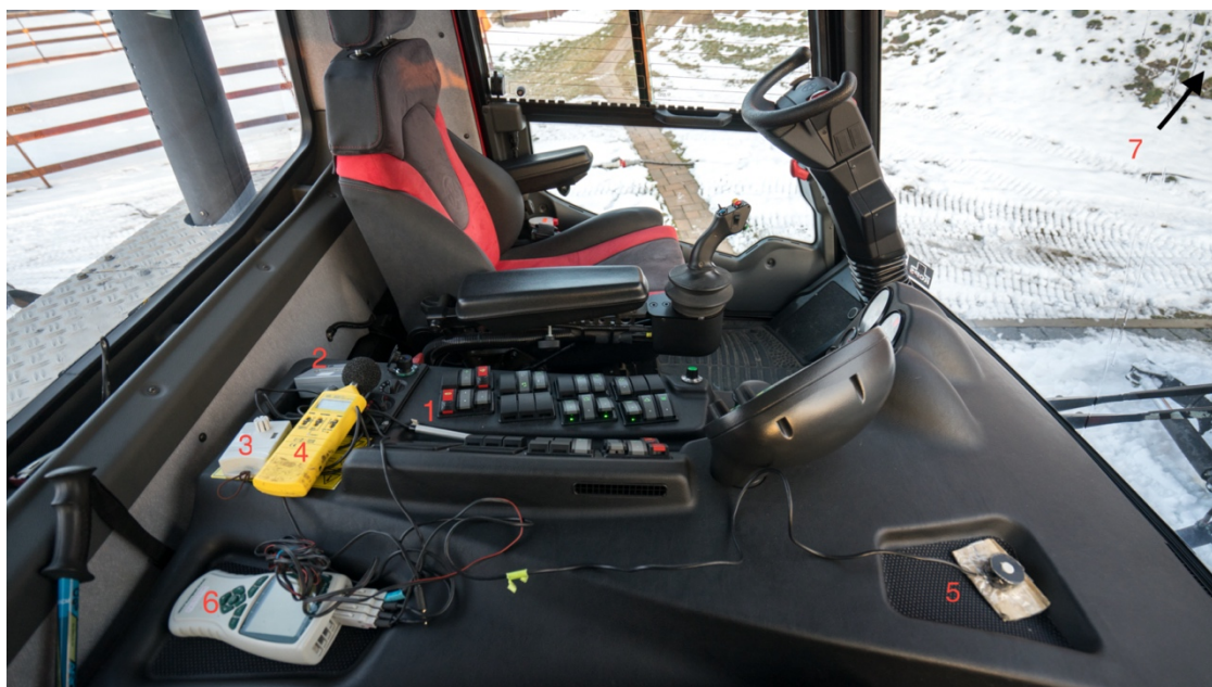
Obr. 19 Rozmístění měřících zařízení
