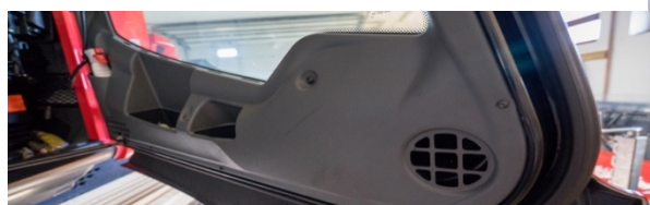
Obr. 16 Průduchy topení ve dveřích
