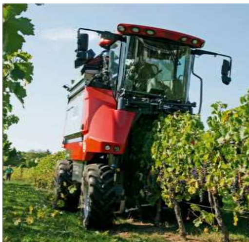
Obr. 2 Kombajn určený na mechanickou sklizeň [8]
