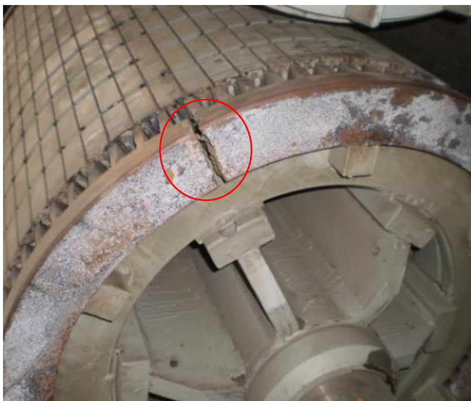
Obrázek 28: Vzorek č. 12 – Prasklý zkratovací kruh rotoru ASM [18]
