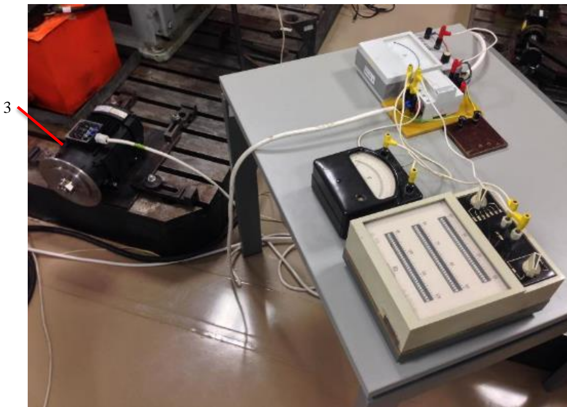
Obrázek 46: Vypínač a obvody pro měření elektrických veličin zkoušeného motoru
