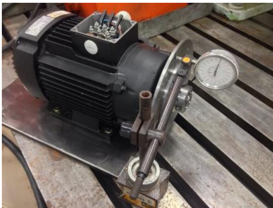
Obrázek 41: Ověření deformace zkušebního kotouče
