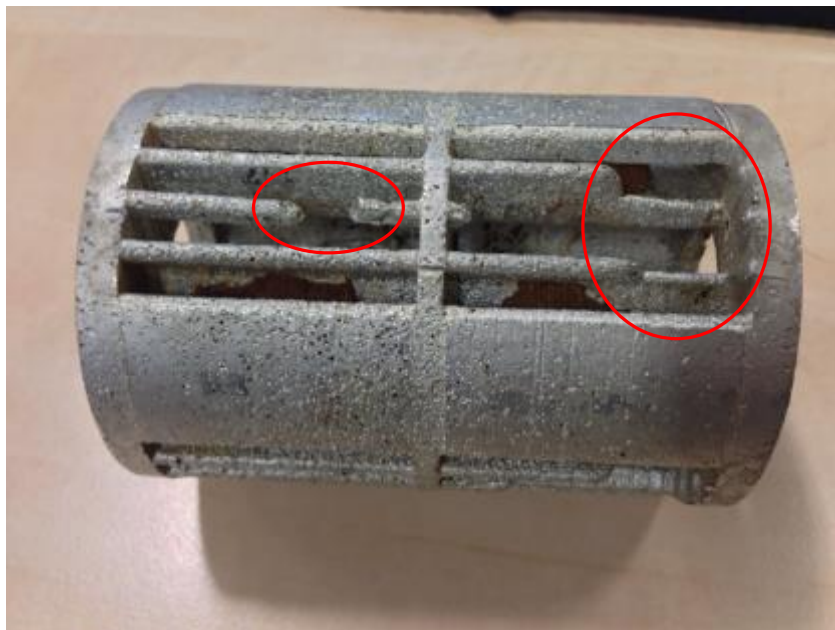
Obrázek 14: Vzorek č. 2 – Neúplně odlitá klec reluktančního motoru
