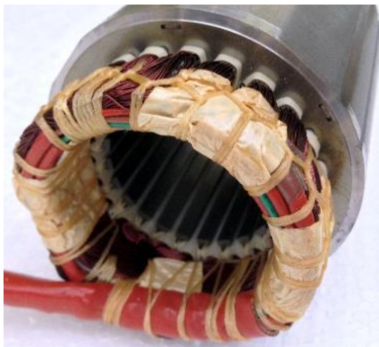
Obrázek 25: Vzorek č. 10 - Přehřívající se stator – čelo vinutí
