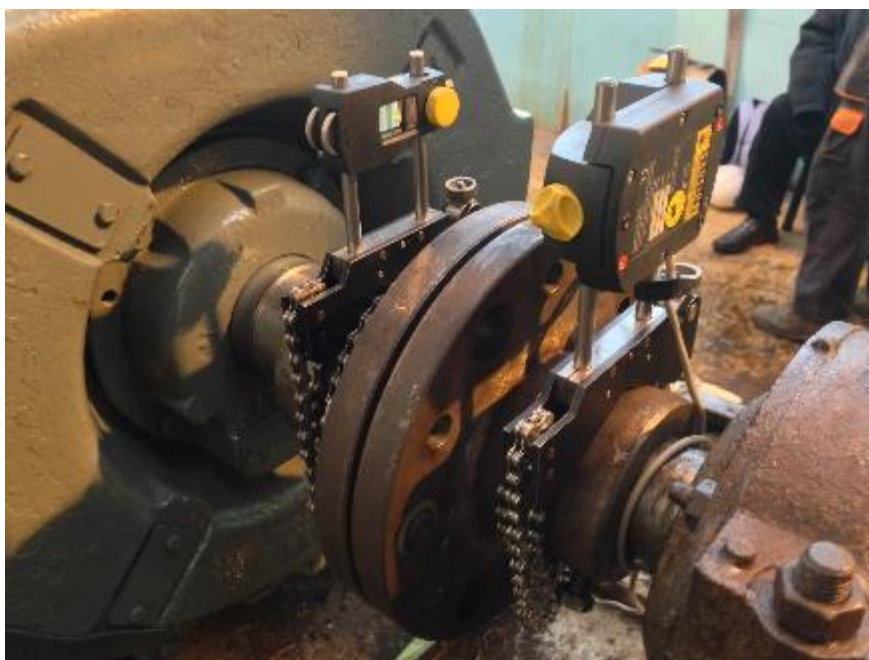
Obrázek 49: Laserové ustavení stroje
