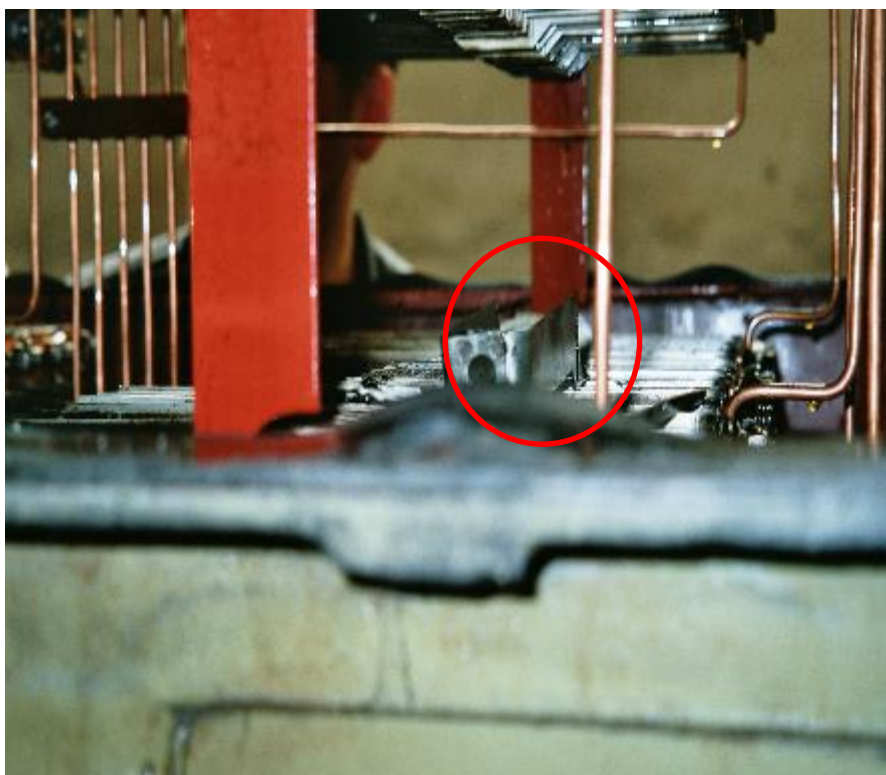
Obrázek 34: Vzorek č. 15 - Zkratovaný odporník upadeným plechem [18]
