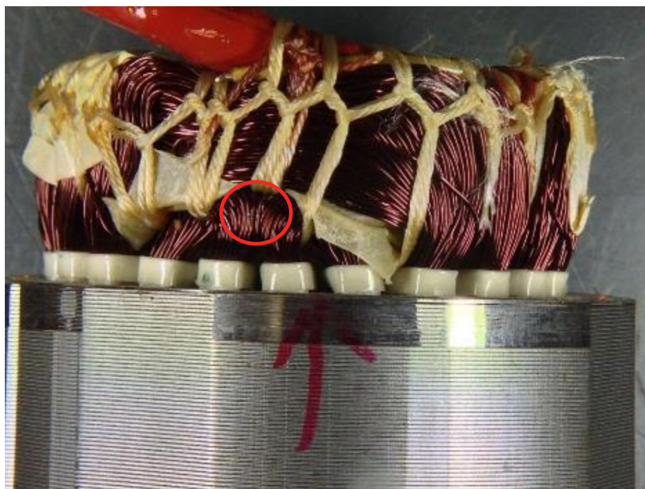
Obrázek 27: Vzorek č. 11 – Mezifázový zkrat – detail vinutí
