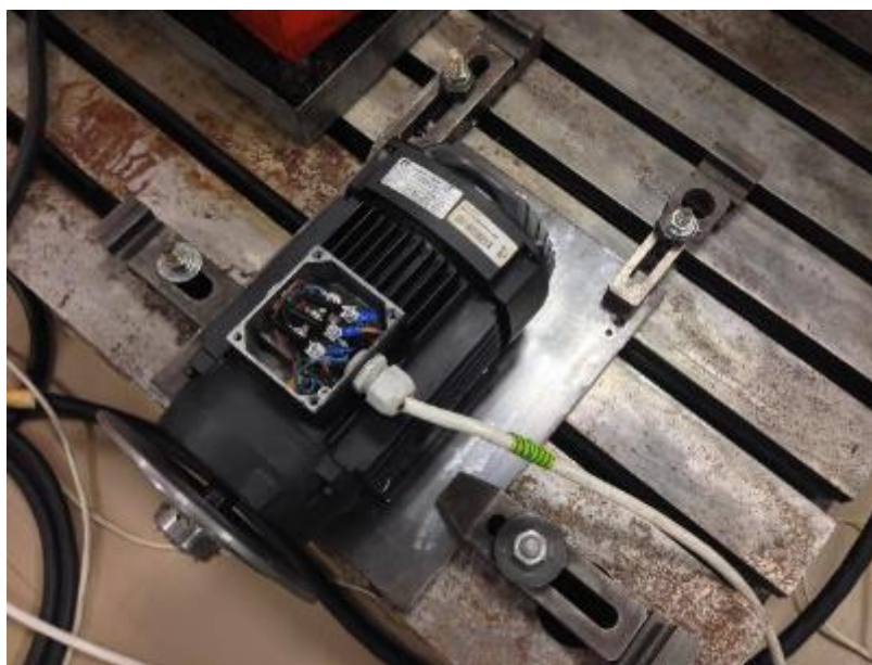
Obrázek 42: Ukotvení zkoušeného motoru k základové desce
