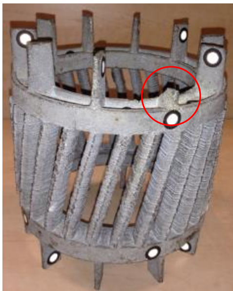
Obrázek 13: Vzorek č. 1 – Neúplně odlitá klec ASM
