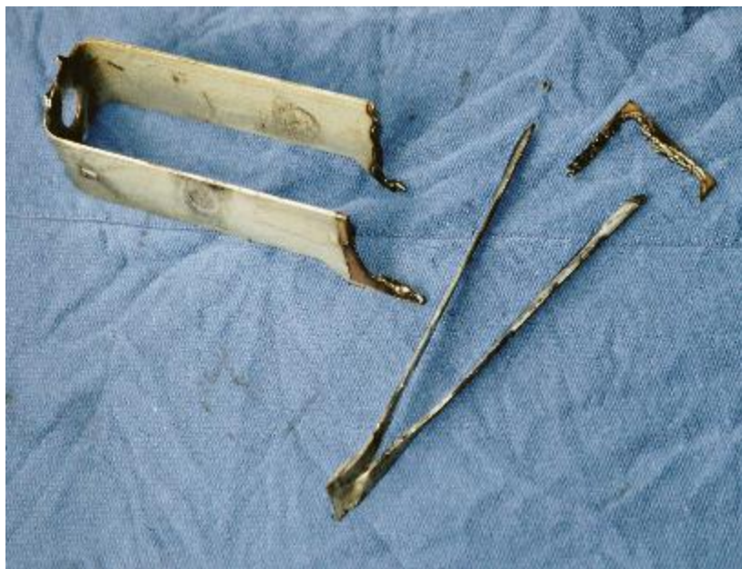
Obrázek 33: Vzorek č. 15 - Upadený odporový plech [18]
