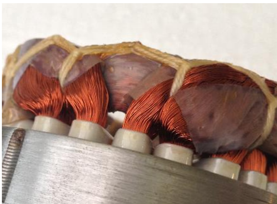
Obrázek 22: Vzorek č. 8 – Poškození vinutí statoru rázovou vlnou – detail vinutí – v tomto případě není poškození viditelné okem
