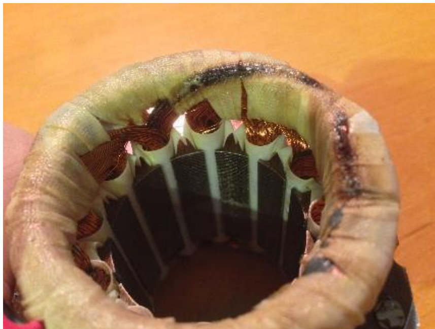
Obrázek 15: Vzorek č. 3 – Mezizávitový zkrat
