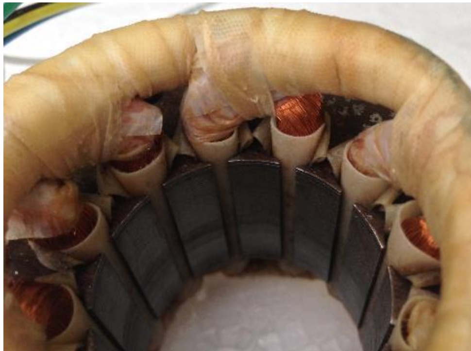
Obrázek 20: Vzorek č. 7 – Poškození vinutí statoru rázovou vlnou – detail vinutí – v tomto případě není poškození viditelné okem
