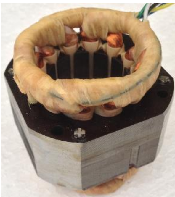
Obrázek 23: Vzorek č. 9 – Přerušené statorové vinutí
