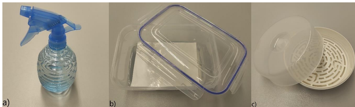
Obrázek 22: Prostředky použité k dekontaminaci vzorků nanovlákných filtračních vrstev. a) používaný rozprašovač, b) nádoba sloužící jako lázeň, c) sterilizátor do mikrovlnné trouby.
