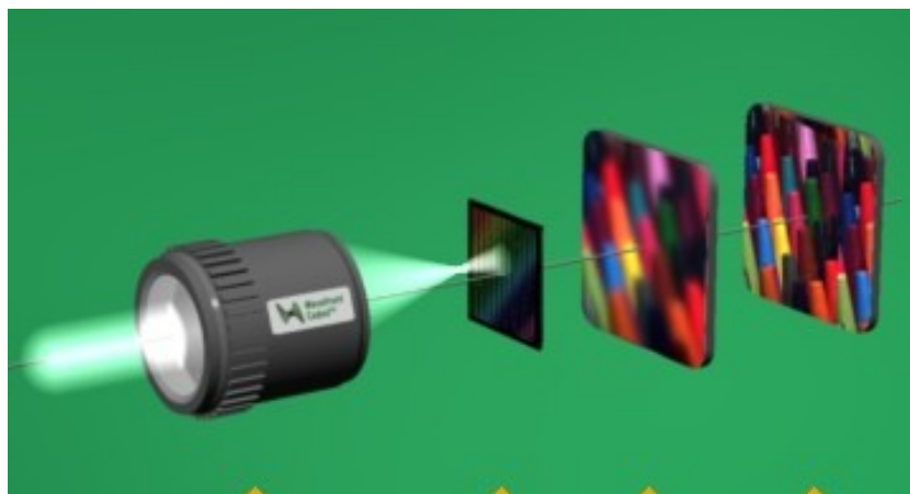
Obrázok 12: Postup spracovania obrazu pri wavefront coding.
