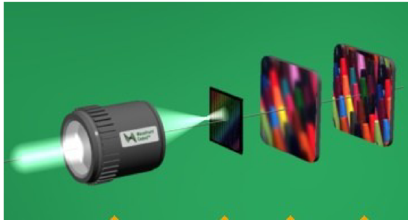
Obrázok 12: Postup spracovania obrazu pri wavefront coding.
