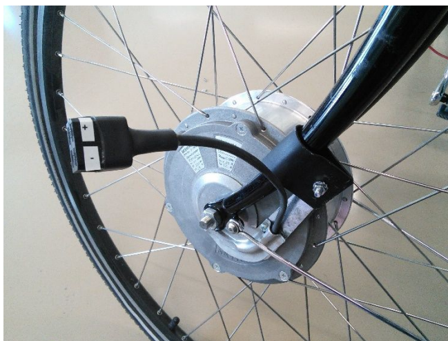
Obr. 8.4: Uchycení elektromotoru a napájecí kabel
