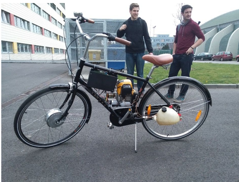
Obr. 8.5: Celý systém namontovaný na kole během testování
