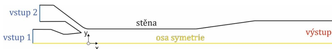
Obr. 4.6: Zjednodušený výpočetní model ejektoru (2D model, osově symetrický, x_p = 3 \text{ mm} ) – poměr stran nebyl z důvodu přehlednosti zachován.
