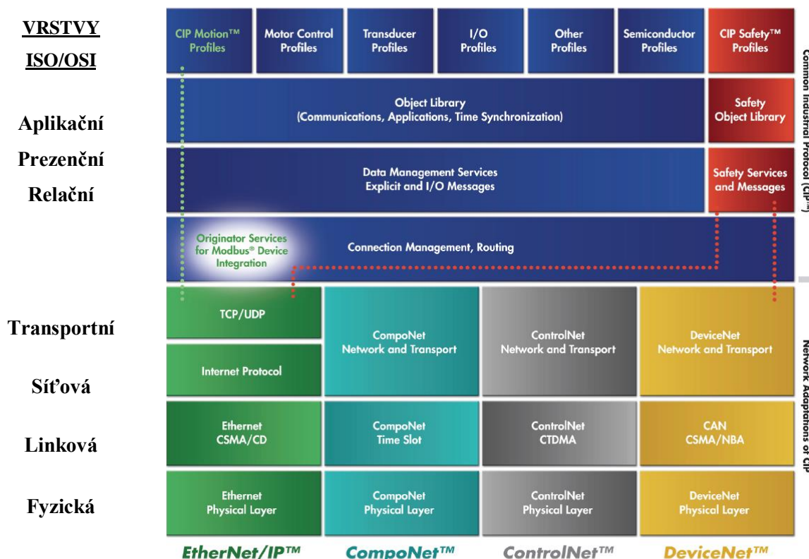
Obr. 3-1 CIP v modelu ISO/OSI [2].
