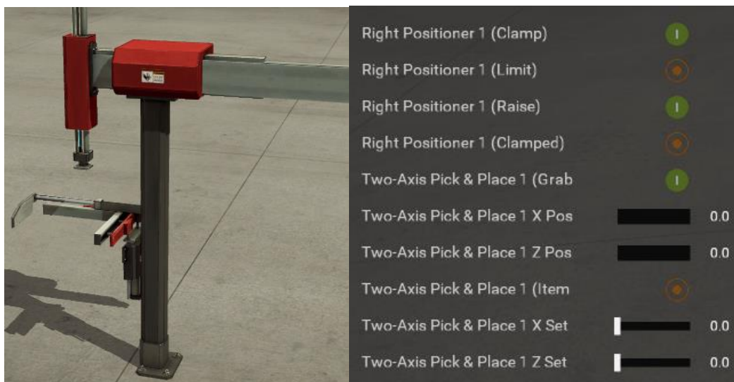
Obr. 6-10 Znázornění dvouosého překladače s ovládáním.
