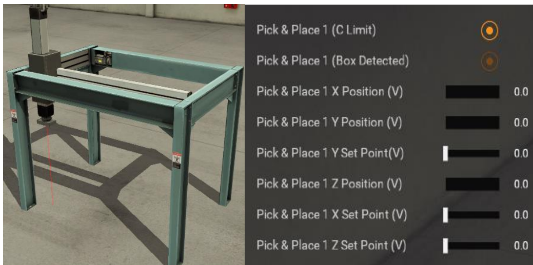
Obr. 6-11 Znárodnění tříosého překladače s ovládáním.
