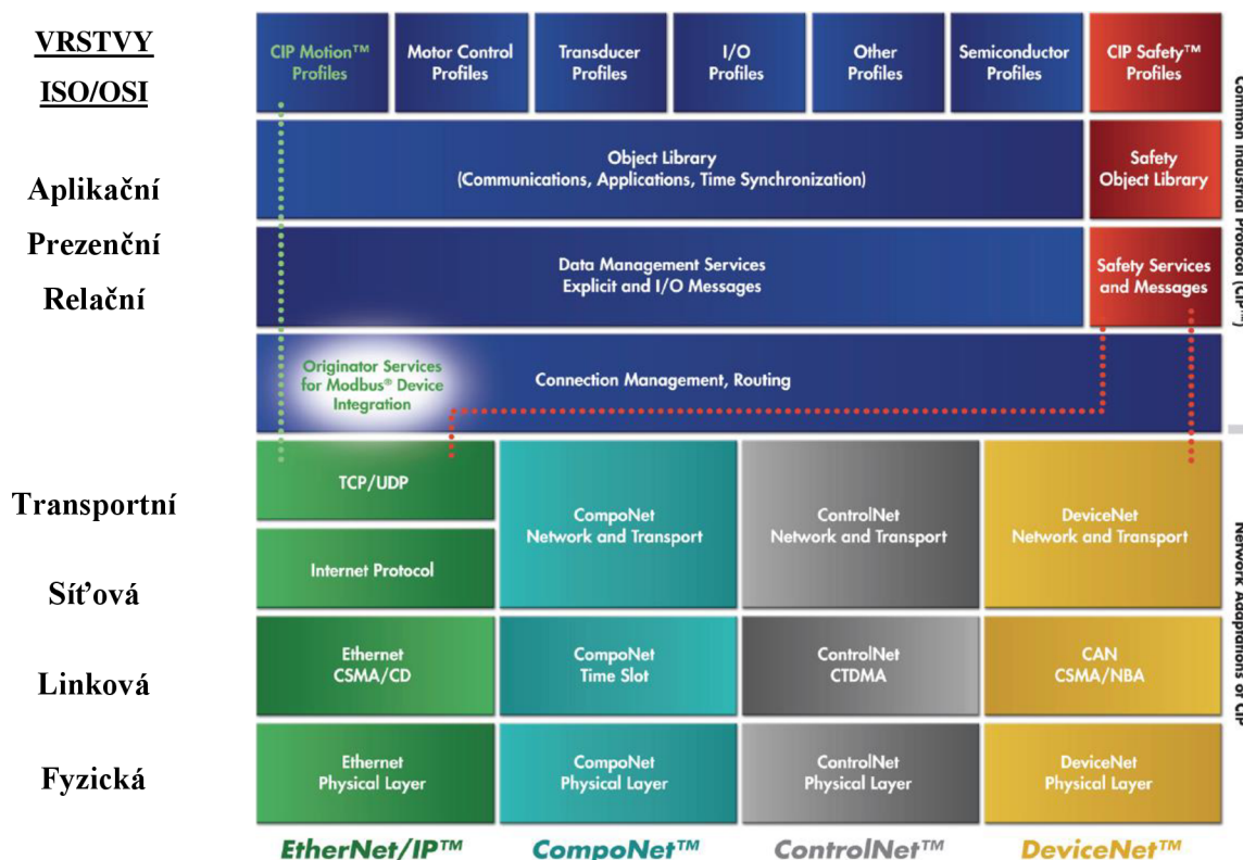
Obr. 3-1 CIP v modelu ISO/OSI [2].
