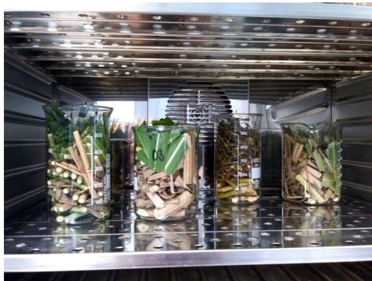
Obrázek 4: Sušení vzorků konopí a ozdobnice v sušárně MEMMERT model 100-800 (foto: vlastní)
