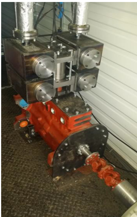
Obrázek 3.9: Parní motor PM-VS [13]
