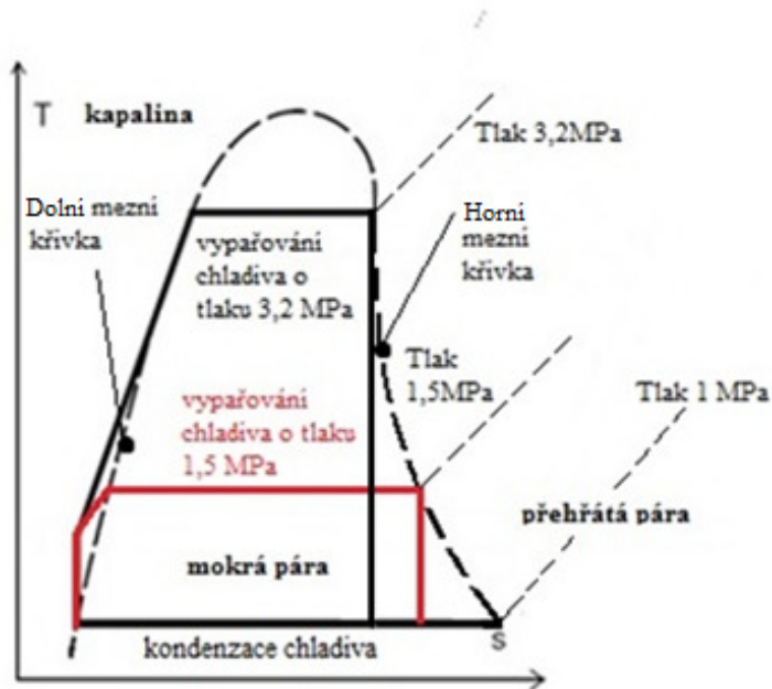
Obrázek 5.3: T-s diagram se zakreslením stavové změny chladiva R134a
