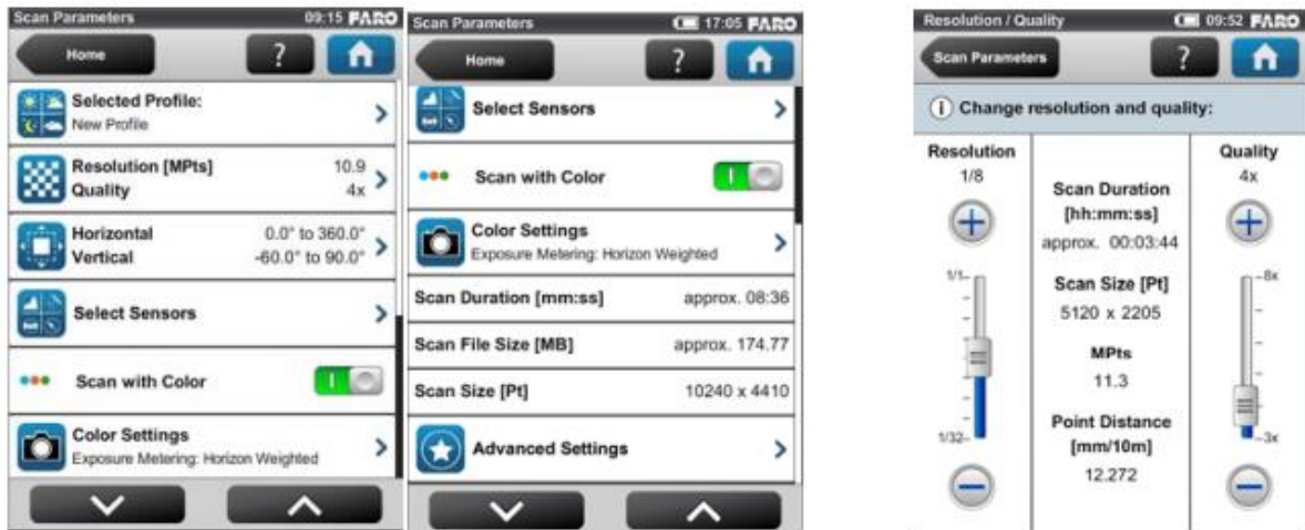
Obr. 19 – Nastavení vlastností skenování (FARO Technologies Inc., 2011)
