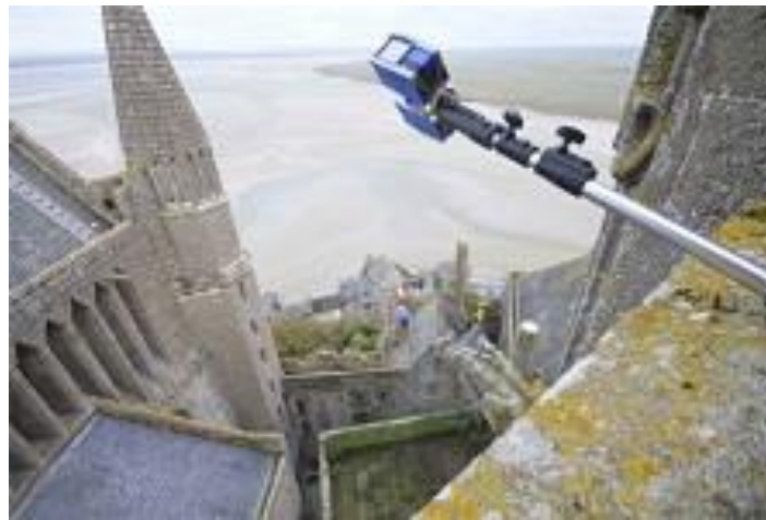
Obr. 8 – poloha skeneru při skenování kláštera Mont Saint Michel (www.faro.com)
