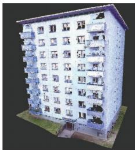
Obr. 9 – Naskenované mračno bodů v programu FARO Scene a ReCap (Sládková, 2014)
