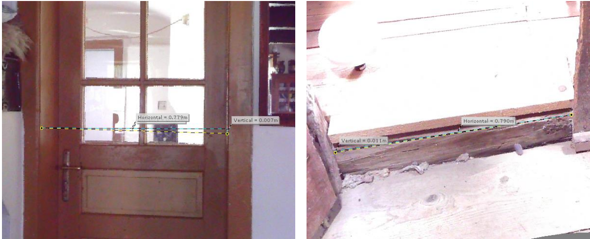
Obr. 29 – Měření vzdáleností v programu FARO Scene (vlastní)
