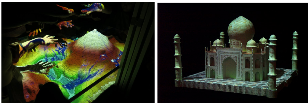
Obr. 2.6: Vľavo: Interaktívne topografické pieskovisko. Vpravo: Aplikácia textúry na fyzický objekt pomocou Shader Lamps.
